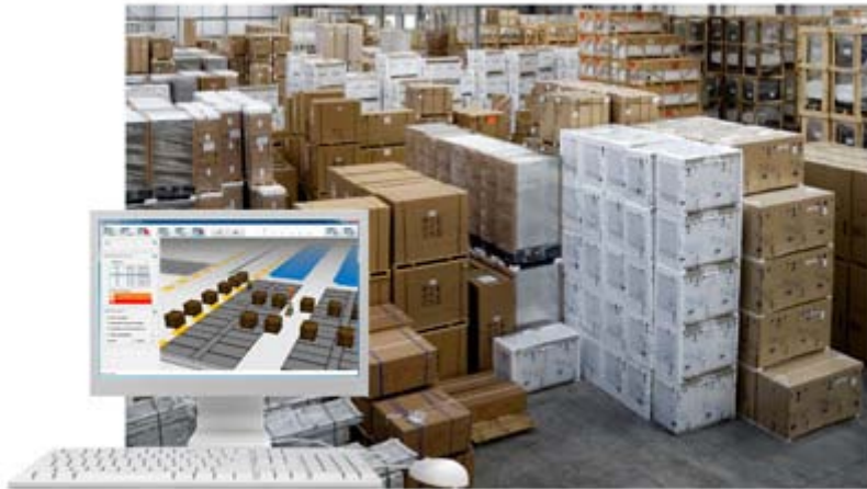
Abb. 3: Der Logistikleiter profitiert von verschiedenen Übersichten im ICS SLS-Leitstand: Ob tabellarische Ansichten oder grafische 3D-Ansicht, wie hier im Bild direkt in SAP®. Alle Transportaufträge und Ressourcen werden im Leitstands-Cockpit in Echtzeit abgebildet. In automatische Routinen kann jederzeit eingegriffen und Prioritäten geändert werden.
