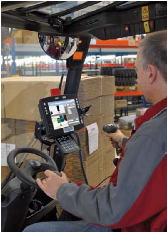
Abb. 2: Die Bestätigung der Ladungsträgeraufnahme mit einem Barcodescanner ist mit dem ICS SLS nicht mehr notwendig. Dank einem auf dem Gabelstapler integrierten Ortungssystem, kombiniert mit entsprechender Sensorik wie z.B. Höhen- und Beladungssensor, ist die ICS Software in der Lage jeden Ladungsträger bis auf wenige Zentimeter genau wiederzufinden, visuell darzustellen und beleglos ohne zusätzliches Scannen im SAP® bzw. STRADIVARI® WMS zu bestätigen.
