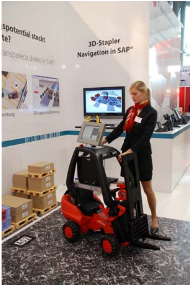
Abb. 5: Mit dem ICS SLS und seinem kamerabasierten Ortungsmodul ICS Stapler-Track, hier im Bild das Demo-System, lassen sich Flurförderzeuge im Innen- und Außenbereich des Lagers effizient in SAP® orten, steuern und überwachen. Komplexe SAP®-Datenstrukturen werden dank 3D-Visualisierung grafisch aufbereitet und übersichtlich dargestellt. Moderierte Live-Vorführungen zum ersten integrierten Staplerleitsystem für SAP® ERP erfolgen täglich im Demo-Park auf dem ICS-Messestand zur CeMAT 2011 in Halle 27 / Stand B38.
