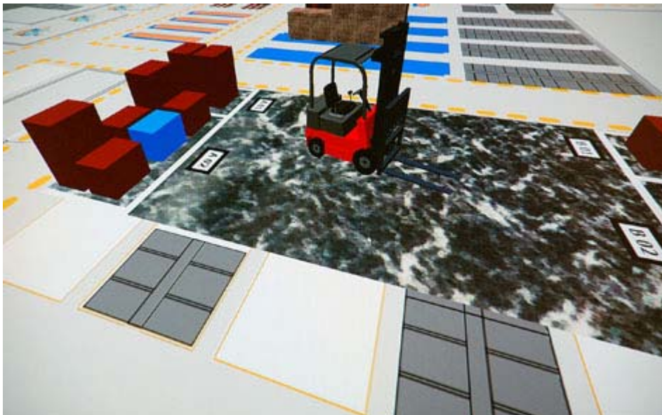
Abb. 3: Durch die kamerabasierte Ortung mit ICS-Stapler-Track wird die Position mobiler Einheiten (Stapler oder Kommissionierwagen) im Innen- sowie Außenlager bis auf wenige Zentimeter genau in Echtzeit bestimmt und an das SAP®-System kommuniziert. Der Logistikleiter hat im 3D-Leitstand jederzeit alle Flurförderzeuge mit Fahraufträgen sowie ereignisaktuelle Meldungsanzeigen im Blick.
