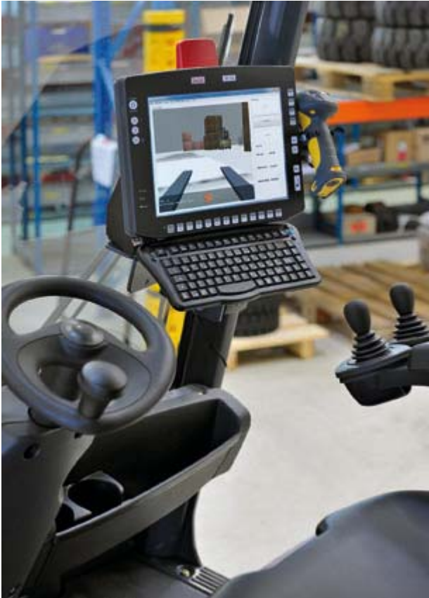
Abb. 4: Im ICS SLS für SAP® kann der Staplerfahrer per 3D-Navigation und Fahrerassistenz wegeoptimiert und prioritätsgesteuert zum nächsten Auftrag geführt werden. Zu kommissionierende Waren lassen sich im grafischen Cockpit farblich darstellen und werden nach erfolgreicher Kommissionierung automatisch im SAP® ERP verbucht. Mobile selbsterklärende Staplerdialoge ermöglichen zudem Responsemeldungen bei Betriebsstörungen.
