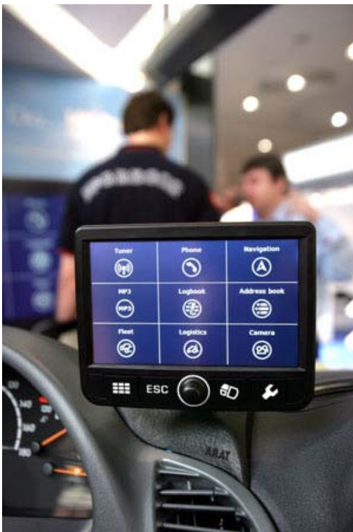
Abb. 3: Viele Vorteile für den Fahrer. Mit dem Bordrechner TeleDrive ® von IAV verfügt der Fahrer über ein Kommunikations- und Infotainment-System mit Telefonie, Radio, MP3 und Video-Funktionen, integriertem Nachrichtenversand sowie proaktiver Fahrerunterstützung. Für den Nutzer stellt ICS mit der Telematik-Software 4mobile Transport ein Profisystem bereit.
