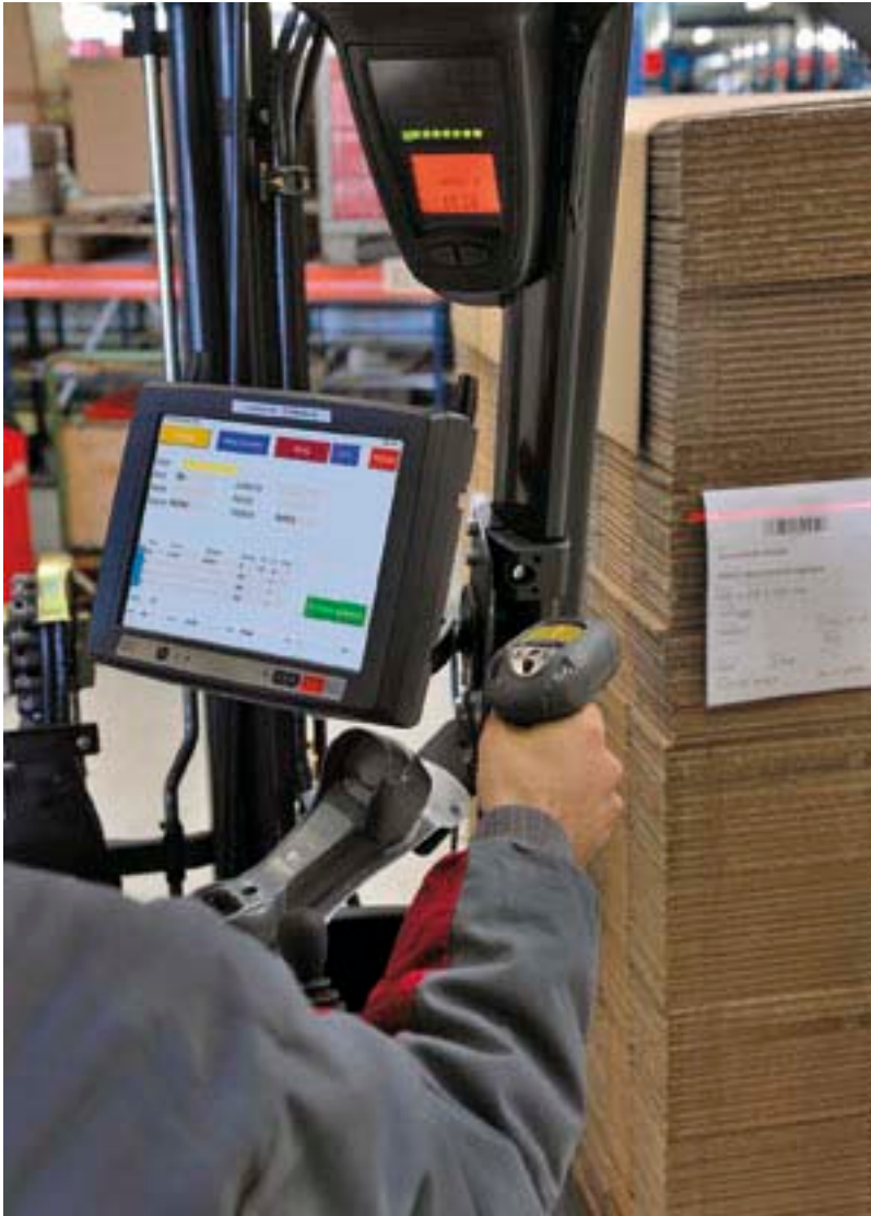
Abb. 2: Mit dem Staplerleitsystem ICS SLS können Fahraufträge direkt in SAP® WM, MM, PP und SD mittels mobiler Stapler-Dialoge abgearbeitet und per Barcode-Scanning oder kamerabasierter Erfassung bestätigt werden.
