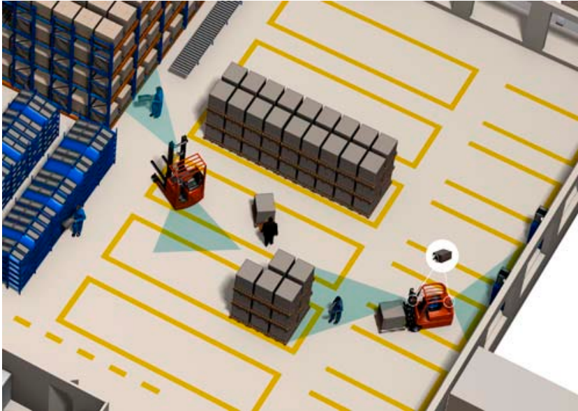
Abb. 3: Das Ortungssystem ICS Stapler-Track übermittelt durch eine rückwärtig auf dem Stapler fixierte Kamera anhand der Bodenkennzeichnung jeweils die genaue Fahrzeugposition. Die Frontkamera dient zur Dokumentation und Identifikation von Waren.
