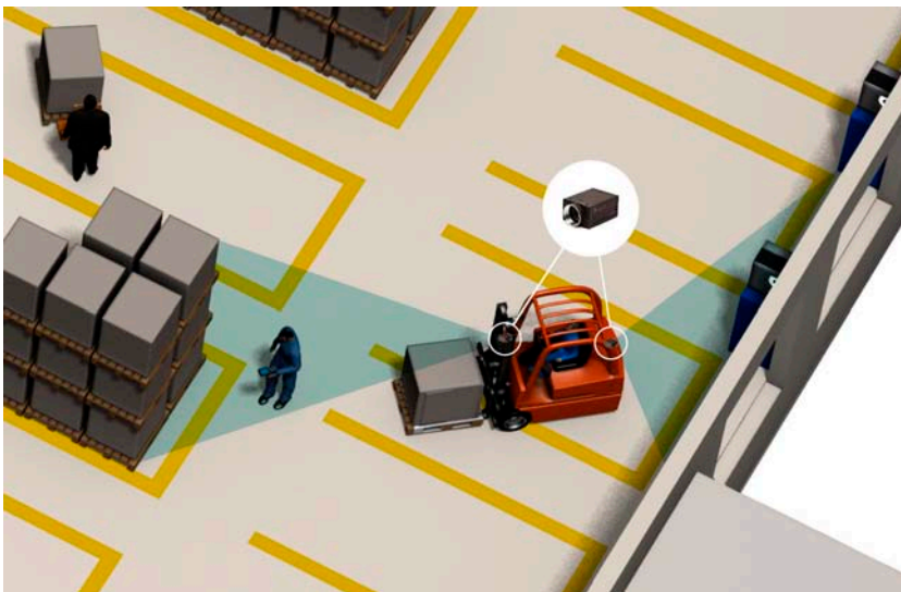
Abb. 4: ICS Stapler-Track ortet bis auf zehn Zentimeter genau. Hierdurch können die Fahrzeugbewegungen in Echtzeit transparent erfasst und für den effizienten Einsatz der Staplerflotte genutzt werden.
