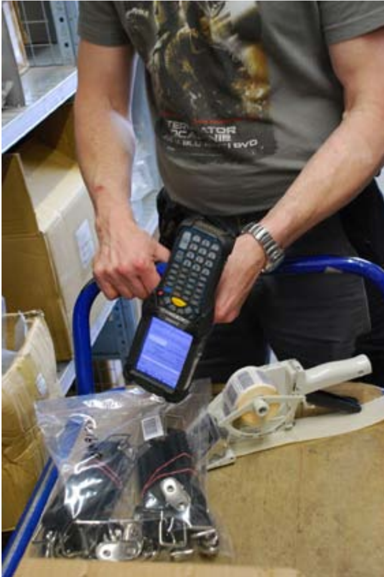
Abb. 3: Das mobile Terminal Motorola MC9190-G ist der Nachfolger des erfolgreich im Einsatz bewährten MC9090-G. Die integrierte Motorola MAX Data Capture Technologie bietet High-Performance-Scanning-Prozesse. Der Anwender wählt entsprechend seiner individuellen Anforderungen entweder Laser, 2D-Imager, beide mit Standard- beziehungsweise optional Extended-Range, oder gar die Direct Part Mark Scannertechnologie für das MC9190-G.
