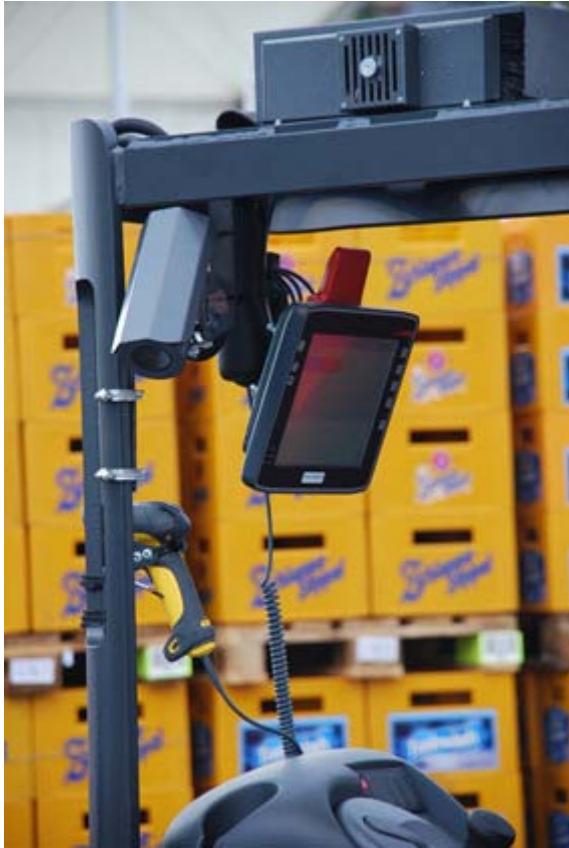
Abb. 3: ICS stattete Linde Schubmaststapler des Typs R16 und Linde Elektrostapler des Typs E16P jeweils mit einem Dlog-Terminal MTC 6/10 sowie einer Kamera aus. In Verbindung mit der Ortungssoftware und aufgebrachten Bodenmarkern konnte die genaue Position des Staplers bestimmt werden.
