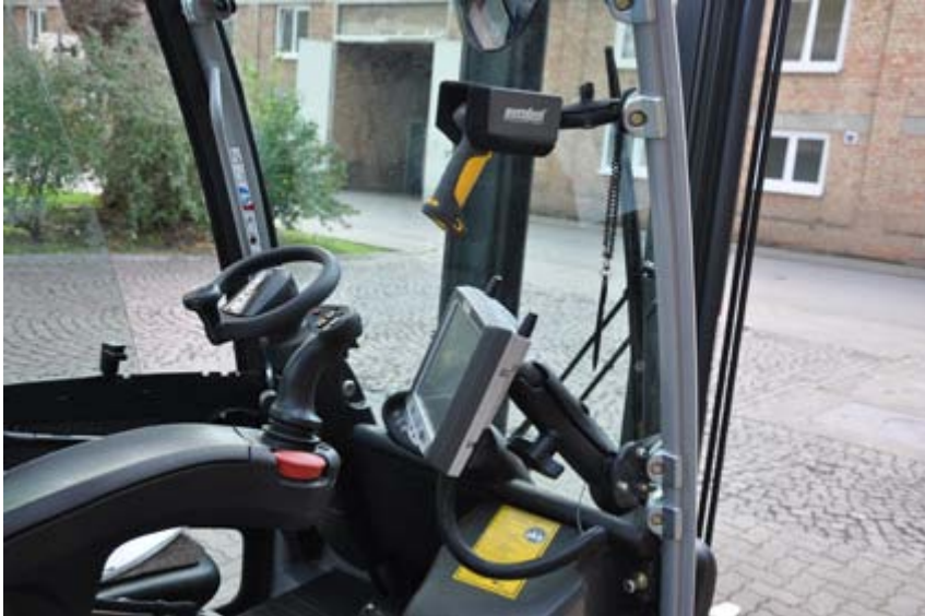
Abb. 2: Einfache Warenbewegungen mit dem Flurförderzeug: KSB-Staplerfahrer arbeiten direkt in SAP® ihre Aufträge ab. Die Datenkommunikation erfolgt über das Staplerterminal VX8 von LXE und den Handschanner LS3578 ER von Motorola.
